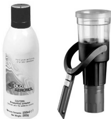
شکل ۶-۱- ( سمت راست ) ابزار تست دیتکتور دود (سمت چپ)مواد گازی
