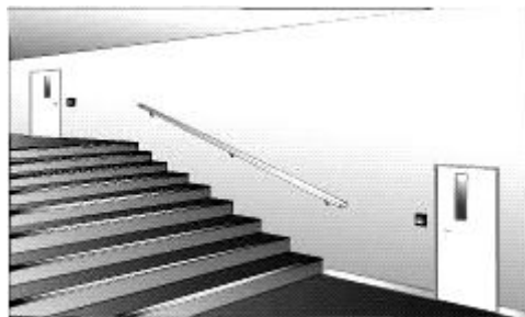
شکل ۴-۴ محل قرار گرفتن کلید اعلام دستی در راهروها
