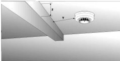
شکل ۴-۲۲ ( فاصله مجاز دیتکتور با مانع روی سقف
