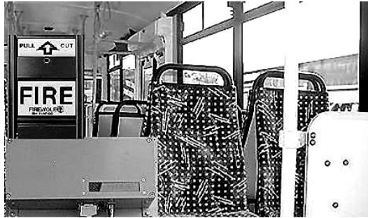
شکل ۲-۱۲ به کارگیری سامانه اعلام حریق رادیویی در وسایل نقلیه عمومی
